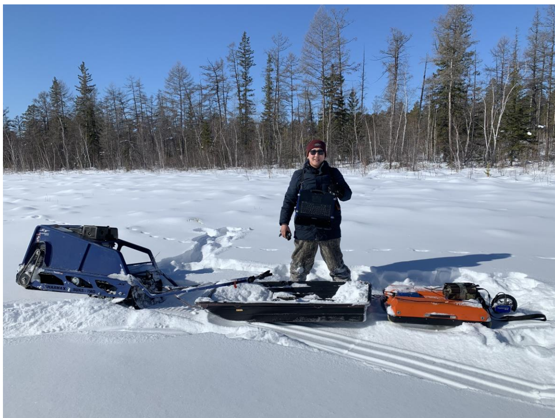
Рисунок 4.6 – Георадарная система в связке с мотобуксировщиком
