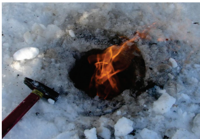
Рис. 3. Горящий газ в устье скважины на льду Туматской протоки (дельта Лены)
