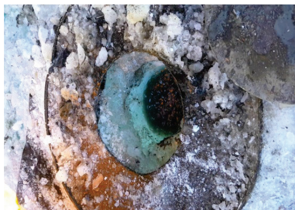
Рис. 2. Бурление метана в устье скважины на Омуде лагуне (Быковский п-ов)
