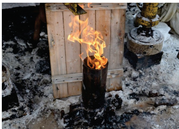
Рис. 1. Горящий газ в устье скважины на мелководном шельфе моря Лаптевых (губа Буор-Хая)
